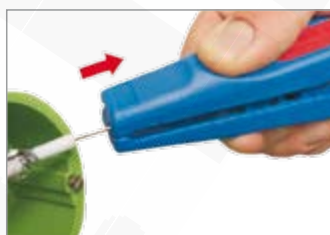
Zdejmowanie izolacji wewnętrznej.
