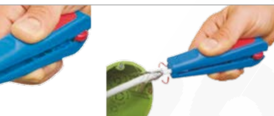
Zdejmowanie izolacji zewnętrznej.
