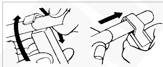
Zdejmowanie izolacji z „konca” kabla
