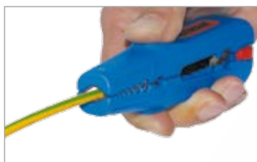
Obwodowe zdejmowanie izolacji z kabli.
