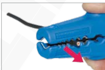
Zdejmowanie izolacji z przewodów.
